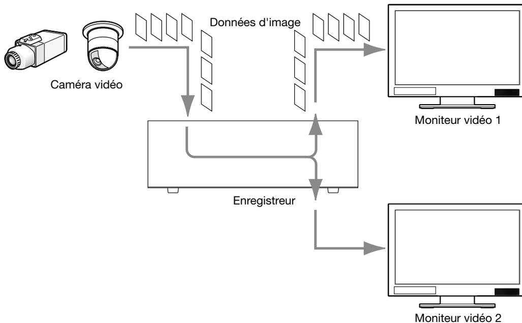
Il est possible d'afficher des images d'observation directe sur un seul écran d'affichage unique ou sur un écran à découpage multiple. Il est également possible d'afficher séquentiellement les images d'observation directe provenant de plusieurs caméras vidéo tout en commutant les canaux de caméra vidéo dans l'ordre (affichage séquentiel).
