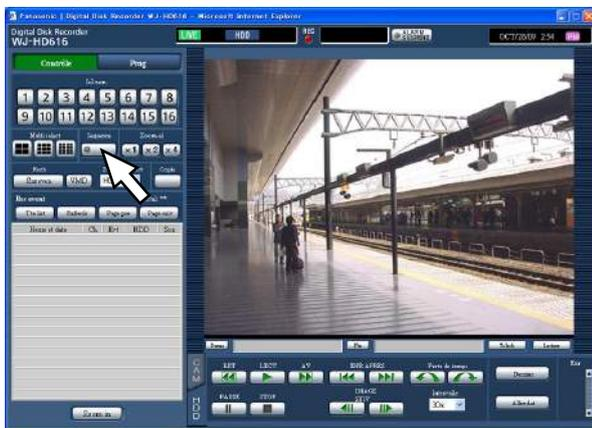
→ Les images d'observation directe provenant de plusieurs caméras vidéo seront affichées séquentiellement en fonction des paramètres configurés à l'avance. L'indicateur sur le bouton [Sequence] s'allume en vert clair et l'indication "SEQ" sera affichée dans la barre d'état.
