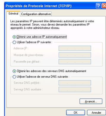
Suivant la configuration du réseau, il est nécessaire de configurer la passerelle par défaut. Se référer à l'administrateur de système pour obtenir de plus amples informations sur les paramétrages.
