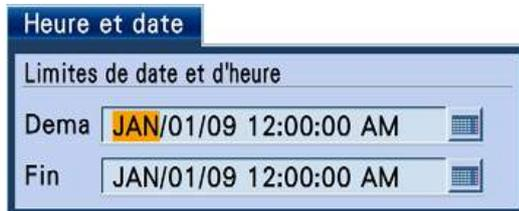
Paramétrer la limite horaire en tournant le volant de commande de marche par impulsions (à l'intérieur). Déplacer le curseur jusqu'au champ de saisie, puis appuyer sur le bouton [SET]. Le clavier de logiciel (pour l'heure et la date saisies) sera affiché et l'heure et la date peuvent être saisies en l'utilisant. Se référer aux pages 21 et 25 pour connaître la façon d'utiliser le clavier de logiciel (pour exécuter la saisie de l'heure et de la date).
