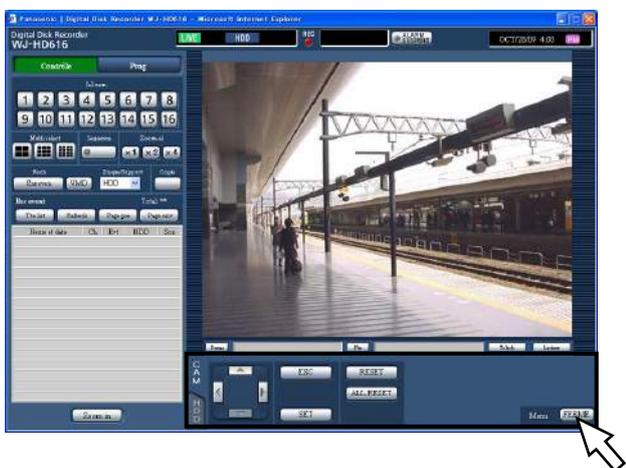
Pour effectuer des opérations dans le menu de configuration de caméra vidéo, se servir des boutons suivants.
